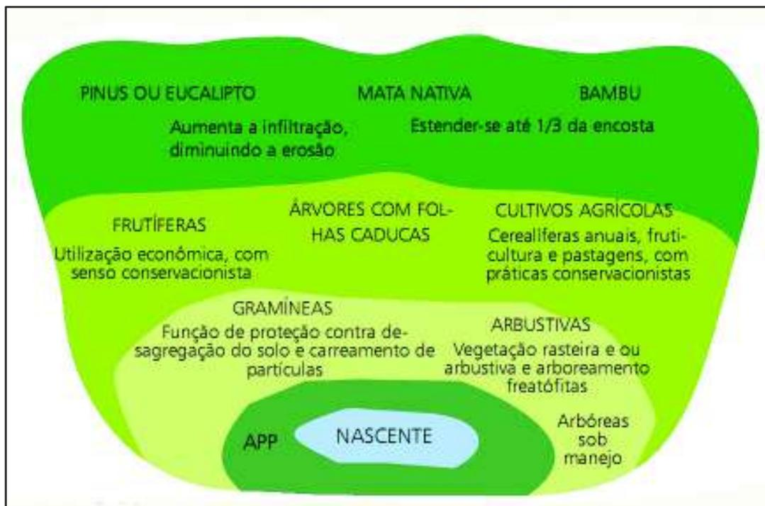
Figura 8.4 - Distribuição adequada das diferentes coberturas vegetais. Fonte: (Calheiros et al, 2004)
