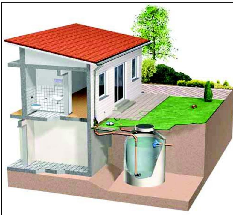
Figura 8.10 - Esquema de captação e reservação de águas pluviais em uma residência
