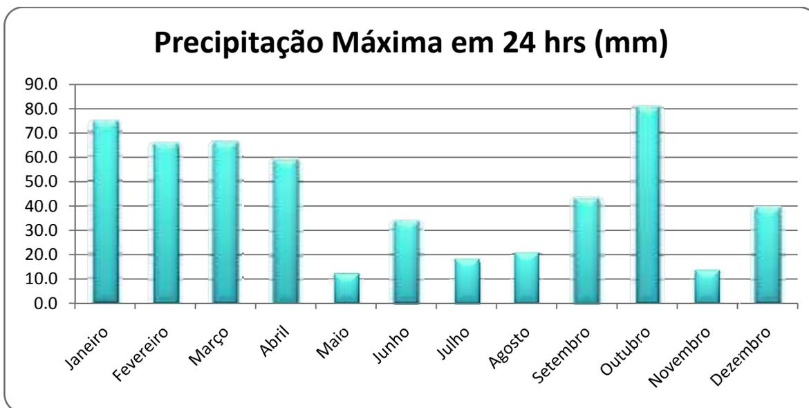
Figura 7.14 - Precipitação máxima em 24 horas em São Ludgero (Fonte: EPAGRI)
